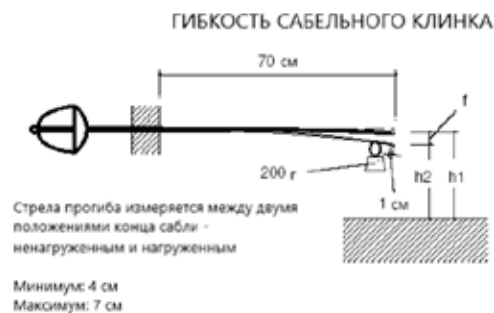
Рисунок 12. Размеры и гибкость сабли
